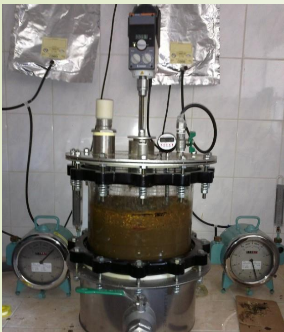
Experimenty s molekulovou bioplynovou stanicí o objemu 25 L s kukuřičnou a travní siláží kontaminovanou 134 Cs o aktivitě až 75 kBq/kg
