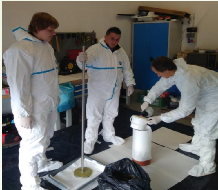
Experimenty s molekulovou bioplynovou stanicí o objemu 25 L s kukuřičnou a travní siláží kontaminovanou 134 Cs o aktivitě až 75 kBq/kg
