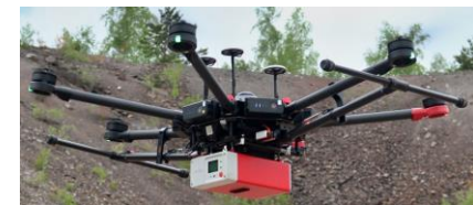
Obr. 5 Sestava dronu a leteckého spektrometru D230A používaná pro gama spektrometrické letecké monitorování
