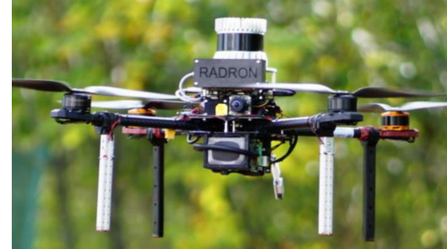
Dron vybavený miniaturní Comptonovou kamerou s detektorem MiniPIX TPX3.
